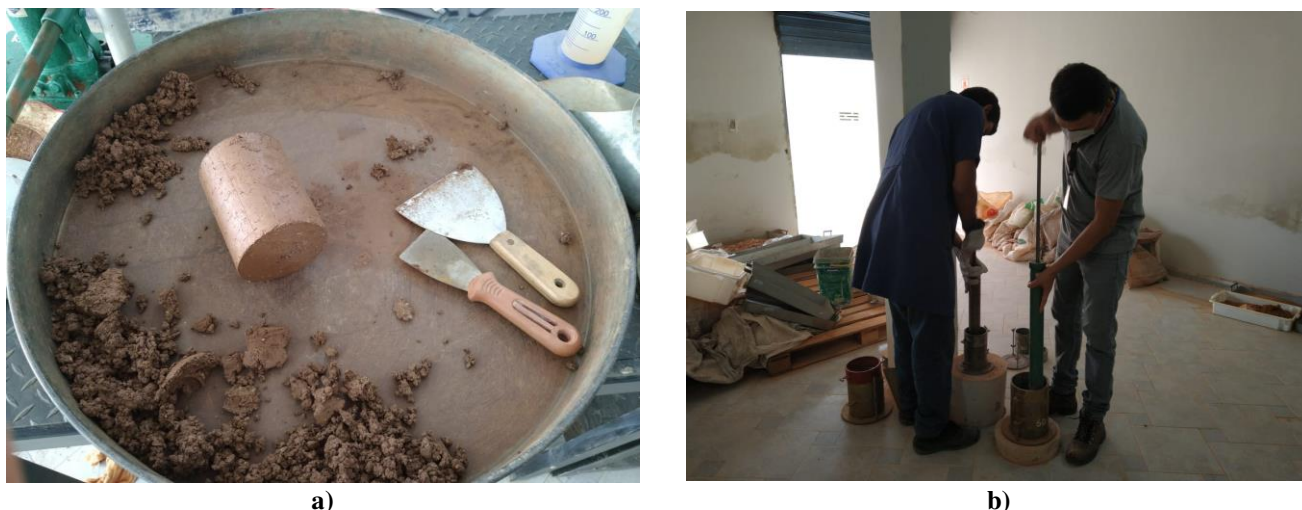
Figura 10: Ensaio em laboratório de Proctor Normal
