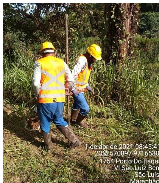
Figura 7: Sondagem a trado no Talude 03
